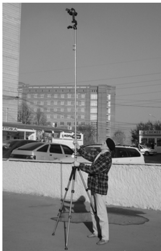
Рис. 2. Вид панорамной головки и высотного штатива в процессе съёмки
